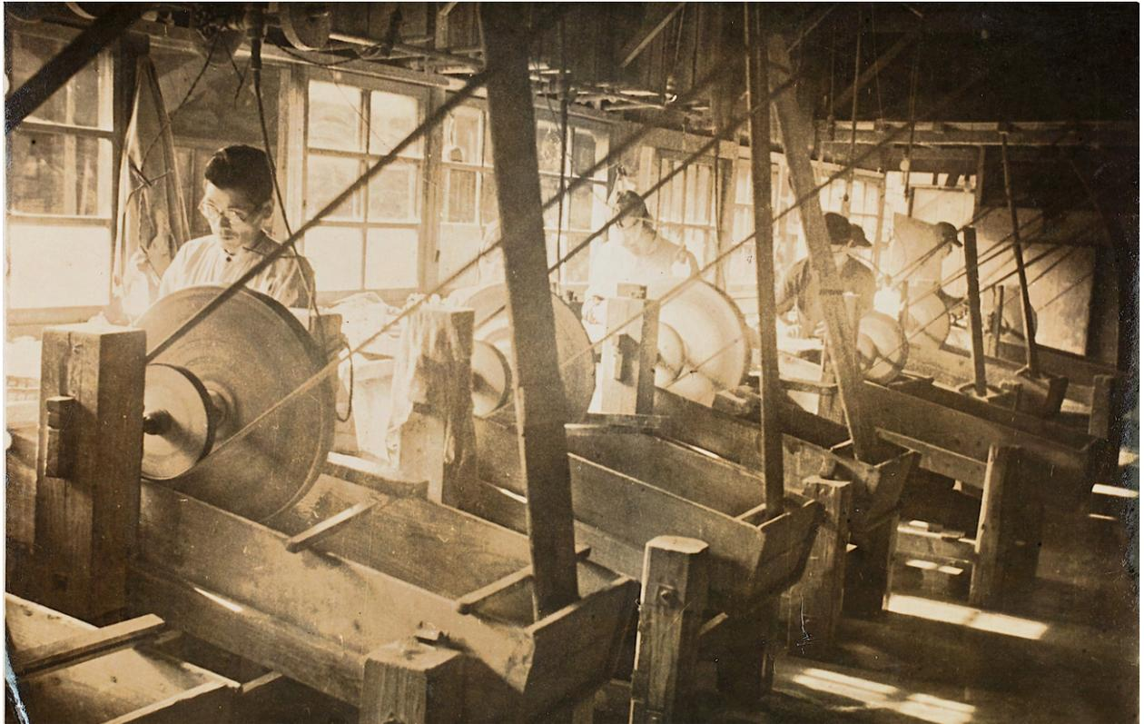
図7:20世紀中頃、東京の堀口硝子のカッティング工房。一台の電動機で数台の旋盤を動かす。この装置と配置は原型の19世紀に設計された英国のカッティング工房ととてもよく似ている。堀口切子のご厚意により転載。
